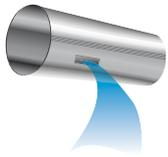
Обычные воздуховоды с решетками или диффузорами распределяют воздух в определённых точках. Результат - неравномерная вентиляция.
